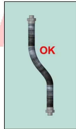
Wird eine Drehdurchführung an eine **Welle mit Axialbewegung** angeschlossen, muss sichergestellt sein, dass in beiden Endlagen kein Kräfte über die Schläuche ausgeübt werden.
